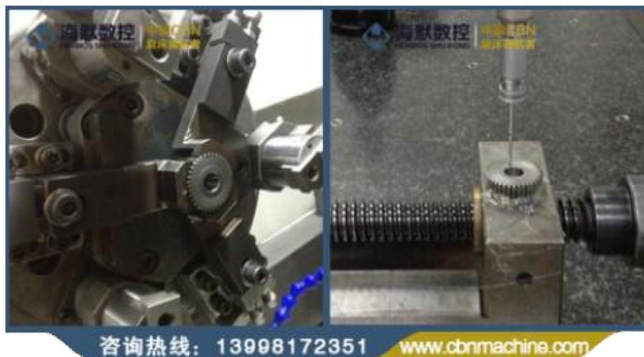
3.精密减速机齿轮内孔及端面磨削视频：
