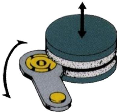
摆臂切入式双端面磨削原理；
